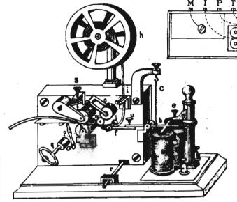
Fig. 5. — Ricevitore o macchina scrivente.
